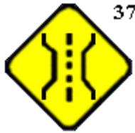
Estrechamiento de camino
