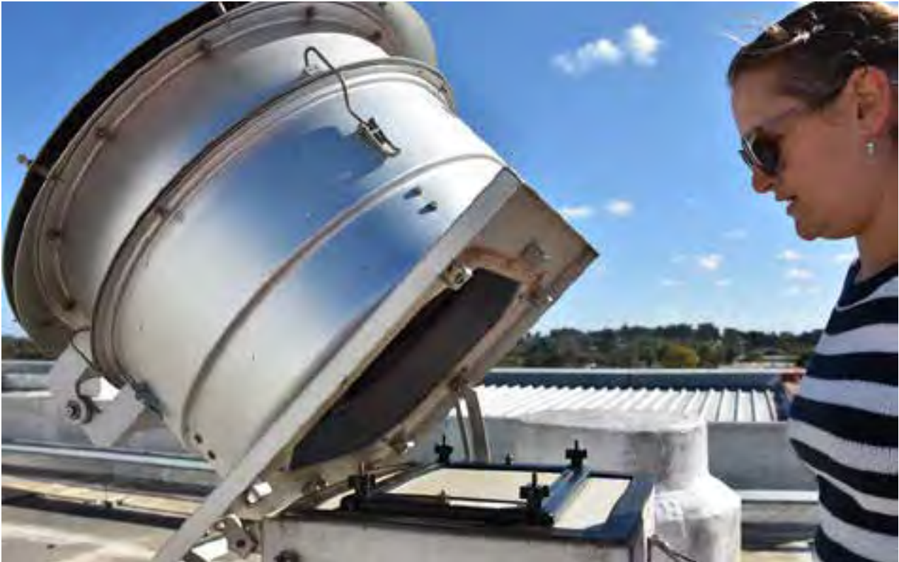
Muestreador manual de alto volumen para material particulado PM10 ubicado en la azotea del Municipio de Ciudad de la Costa.
