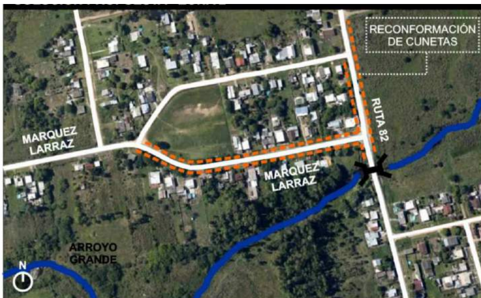
Figura 6.3.3 Solución propuesta esquina Butter y Brausse. Arroyo Grande Fuente: Estudio hidrológico-hidráulico del arroyo Grande y cañada sin nombre.
