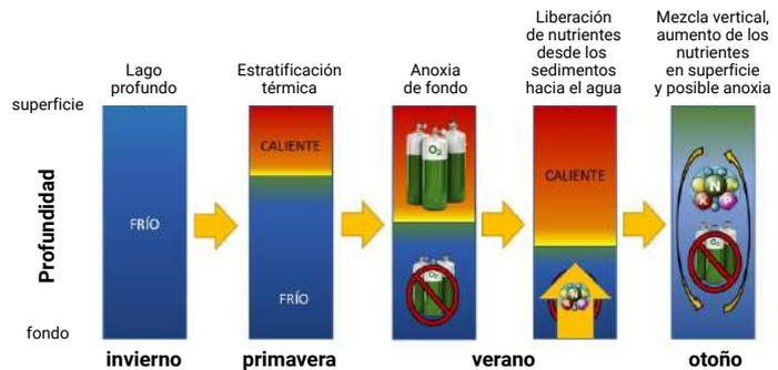
Ilustración 29. Variabilidad vertical de la temperatura de la columna de agua de un lago profundo no cubierto por plantas de la costa de Canelones, ciclo intra-anual.
