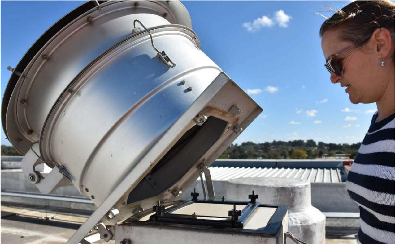
Muestreador manual de alto volumen para material particulado PM10 ubicado en la azotea del Municipio de Ciudad de la Costa.
