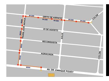
Detalle de la obra: construcción de un colector pluvial de 770 m en Avda Maestro Julio Castro y calles Padre José Novoa y Grito de Asencio.
